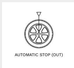
Die Maschine stoppt automatisch in der externen Unwuchtposition.
